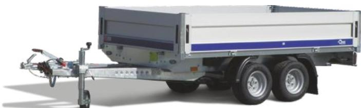
Der Hochlader von Blyss ist in zahlreichen Versionen erhältlich. Lieferbar bis 2.700 kg ZGG mit Innenlängen von 2,60 m bis 4,00 m und Innbreiten von 1,50 m bis 2,00 m, sowie mit verschiedenen Reifengrößen. 10" Niederflurbereifung mit hoher Laufruhe bis 14" großdimensionierte Qualitätsbereifung. Die Hochlader verfügen über einen geschraubten Rahmen, Gummifederachsen sowie Aluminium Bordwände 40 cm.
