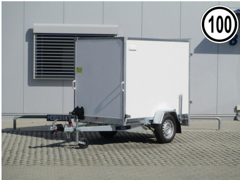
Außenmaße des Koffers mit Heckklappe: L: 352cm x B: 170cm x H: 200cm
