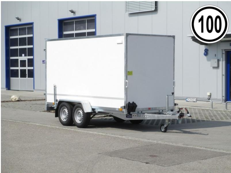
Außenmaße des Koffers mit Heckklappe: L: 512cm x B: 202cm x H: 233cm
